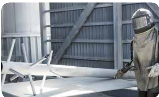
Urządzenie do metalizacji natryskowej cynkiem dla detali dowolnej wielkości.
